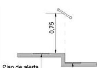
a) Barra de apoio inclinada
