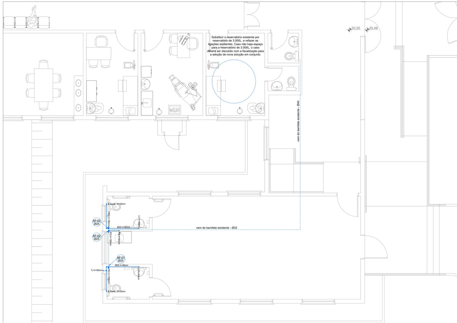
Substituir o reservatório existente por reservatório de 3.000L, e refazer as ligações existentes. Caso não haja espaço para o reservatório de 3.000L, o caso deverá ser discutido com a fiscalização para a adoção de nova solução em conjunto.
